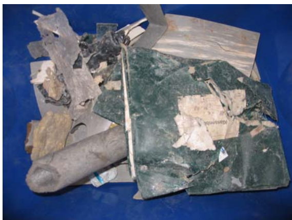
Abbildung 12: FT in einer Sortierprobe Anlagen, die mit gemischtem Gewerbeabfall bestückt werden, weisen im Mittel Stückzahlgehalte um die 4% auf. Das in 38 Sortierungen ermittelte 95er-Perzentil liegt bei 7%.
