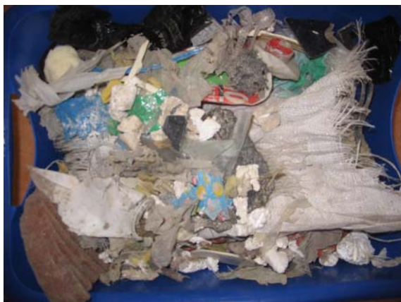
Abbildung 11: NFT einer Sortierprobe Die Stückzahlgehalte liegen im Mittel bei etwa 40%. In den Einzelfractionen sind Gehalte zwischen 25 und 55% angetroffen worden.
